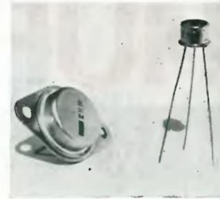
Una caratteristica insolita del SC60 e del SC61 è una resistenza integrata di 100  $\Omega$  posta fra la «gate» ed il catodo, che evita l'innesco accidentale del dispositivo.
