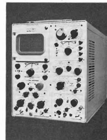
Un oscillografo da 30 MHz molto recente (Marconi TF 2201). Questo strumento dispone di unità ad innesto per deflessione X e Y; nella realizzazione è stata posta particolare cura ai fini della sicurezza e della facilità di manutenzione. Insieme sono visibili il preamplificatore Y a doppia traccia e l'unità singola di base dei tempi.
